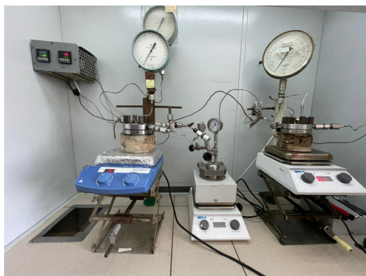
Рис. 1. Автоклавная установка для реакции гидроалкоксихарбонилирование олефинов
